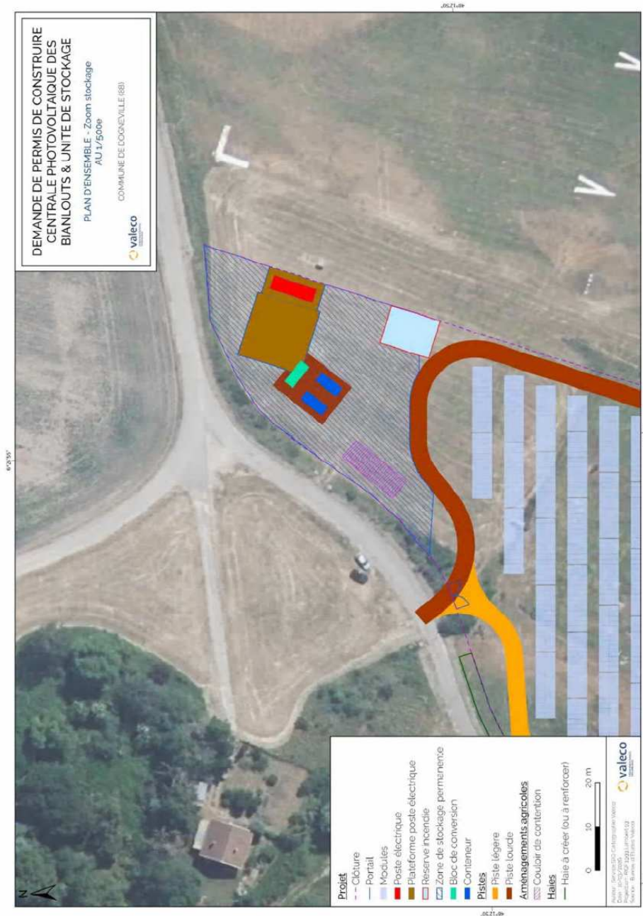
Figure 11 - Plan d'implantation envisagé pour l'ajout de batteries de stockage à la centrale photovoltaïque
